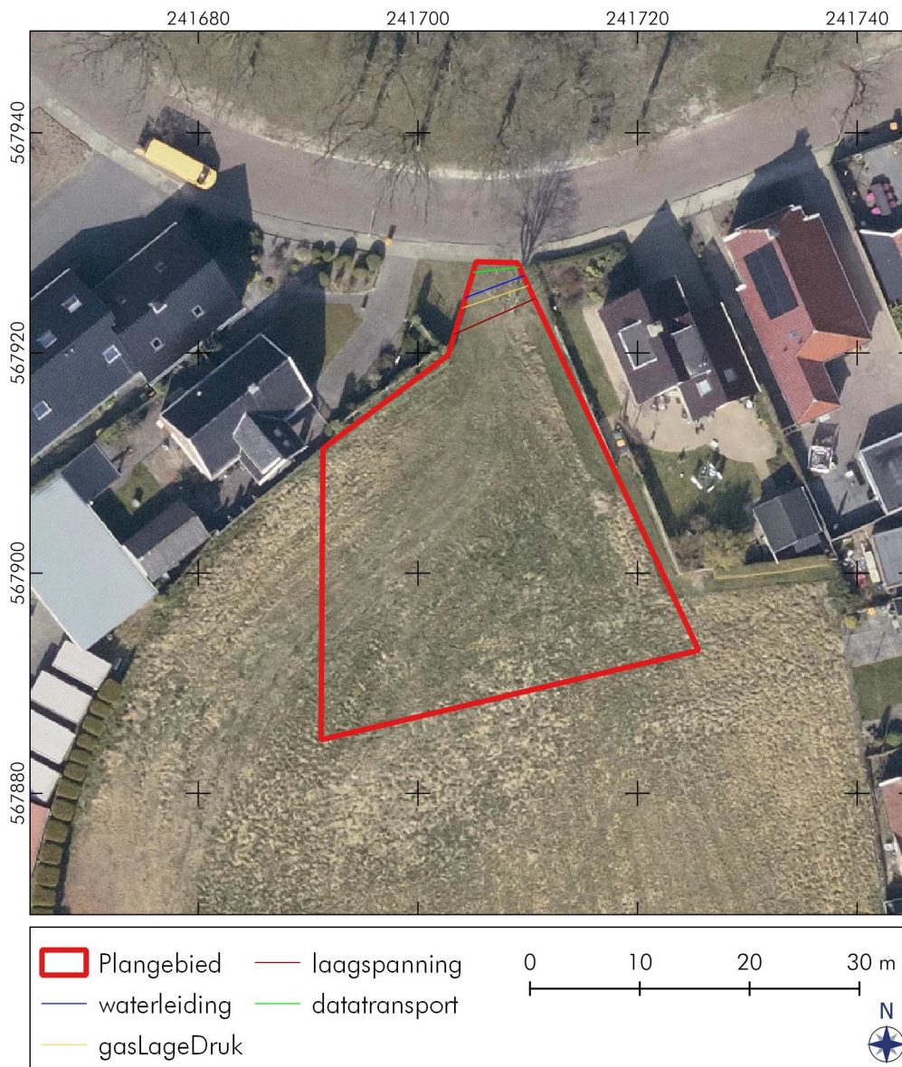
Figuur 2: Zuidlaren, Zuiderstraat 30-32: Luchtfoto van het plangebied met in de locaties van de daarin aanwezige kabels en leidingen (Bron: KLIC-melding 23G0216408).
