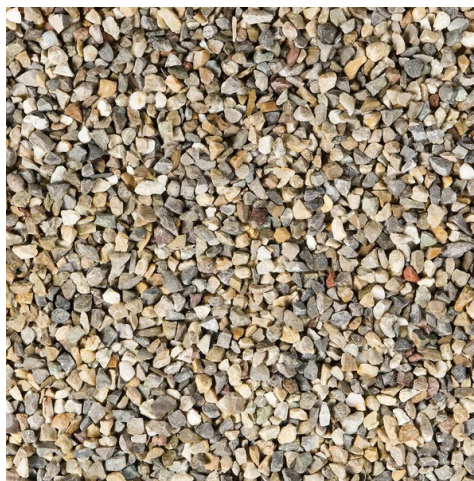
Ontsluitingsweg heeft een toplaag van moraine 2/6mm
