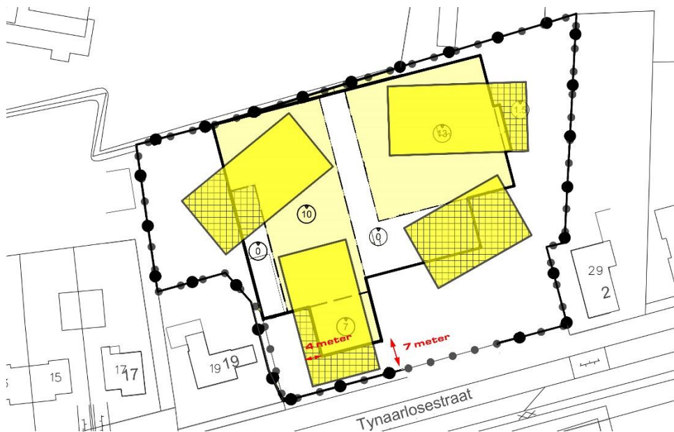
Figuur 1. Vergelijking bouwblokken voorliggende plan en beheersverordening Vries. Gearceerde gedeelte ligt buiten het bouwvlak van de beheersverordening.
