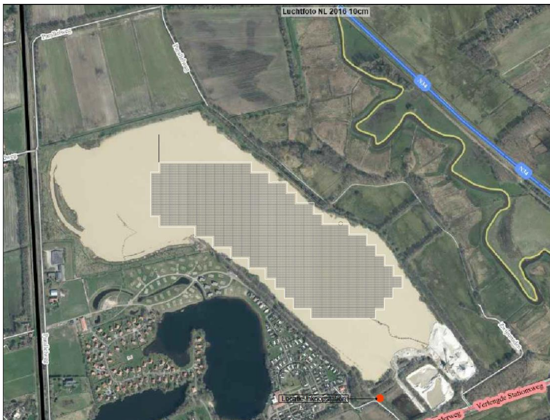
Indicatieve opstelling drijvend zonnepark en locatie inkoopstation (rode stip)
