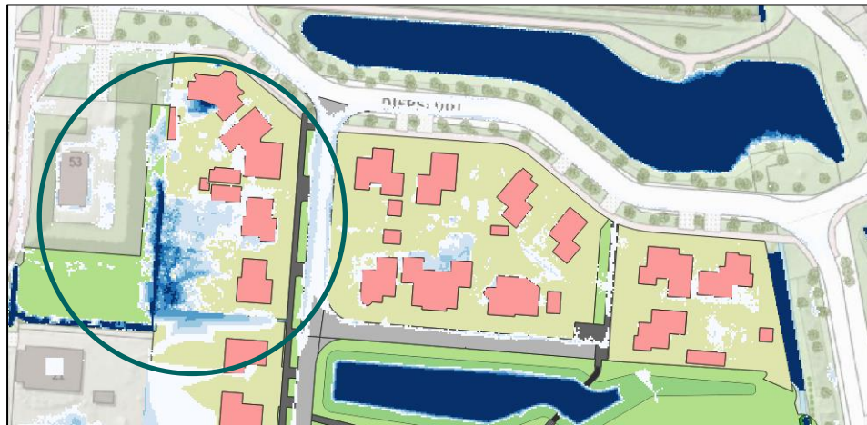
Figuur 5-1: Locatie van water in de achtertuinen van de panden bij Graskampen. Focus van de extra varianten ligt op het verminderen van deze hoeveelheid water.
