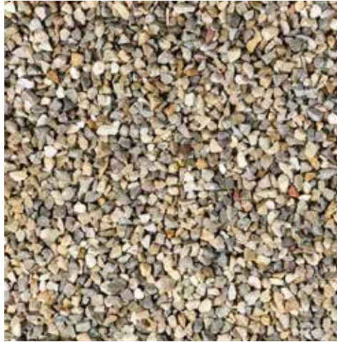
Ontsluitingsweg heeft een toplaag van moraine 2/6mm
